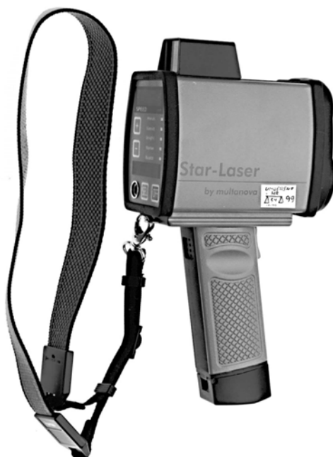
Slika 1. Mjerilo brzine vozila u cestovnom prometu tipa STAR-LASER
